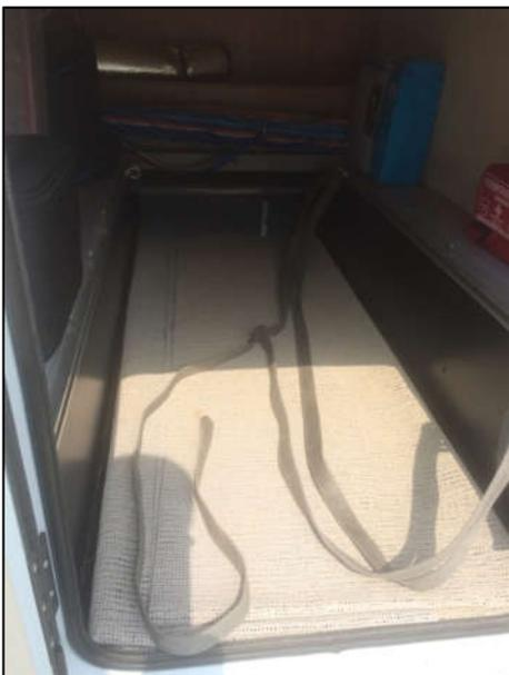
2. Den Tisch mit der Unterseite zum Heck zeigend in die ausgelegte Schlaufe stellen. Dabei den Tisch leicht schräg durch die Staufachöffnung einführen, ganz nach Fahrzeug Rechts schieben und dann an die Rückwand klappen, so dass die Tischplatte senkrecht steht. Darauf achten, dass der Tisch weit genug bis zum Anschlag eingeschoben ist. Dann ist die 2. Verzurröse
